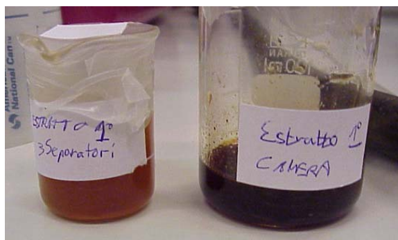
Fig. 45 Gli estratti riuniti dei tre separatori e l'estratto della camera ottenuti dalla prima estrazione mediante \text{CO}_2 supercritica e \text{SO}_2 come cosolvente
