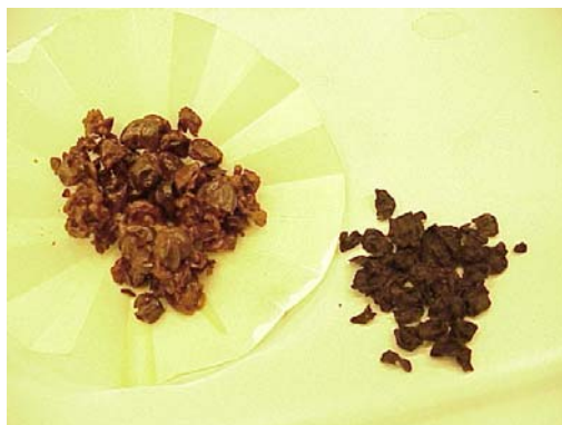
Fig. 50 Le bucce d'uva messe a contatto con l'etanolo dopo l'estrazione con Separex SFE-500 rimangono decolorate permanentemente (a sinistra). Si noti la differenza di tonalità rispetto a bucce fermentate ed essiccate non sottoposte ad estrazione (a destra).
