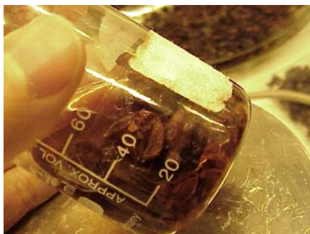
Fig. 48 Le bucce dopo l'estrazione vengono immerse in etanolo: il solvente prende una tonalità marrone scura mentre le bucce rimangono decolorate.
