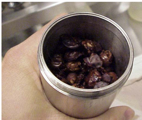
Fig. 46 Le bucce d'uva dopo la prima estrazione con CO 2 supercritica e acido solforoso: nel panierino appaiono decolorate ma non totalmente.
