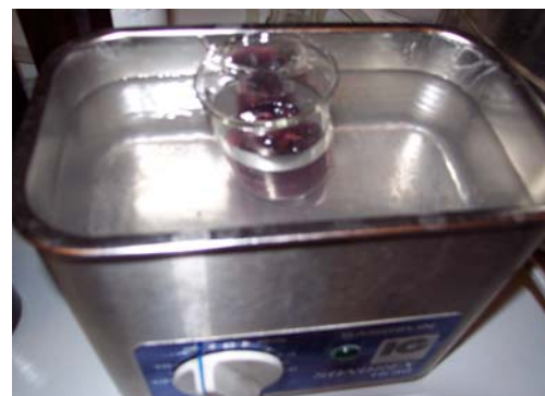
Fig. 29 Macerazione in bagno ad ultrasuoni
