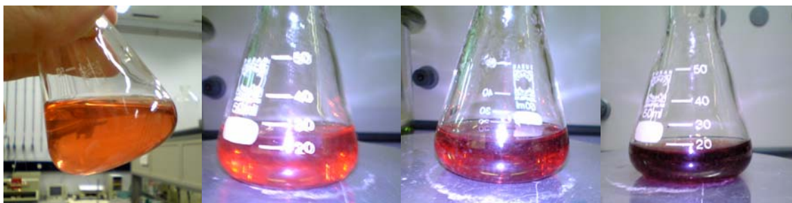
Fig. 36 La soluzione di acido solforoso e antociani sottoposta a riscaldamento. Come si nota dalla sequenza di immagini con l'avanzare del processo, la soluzione si scurisce progressivamente in funzione dell' \text{SO}_2 evaporata: gli antociani stanno recuperando colore.
