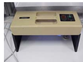
Fig. 41 Lampada UV per analisi cromatografica
