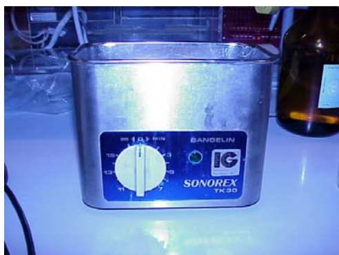
Fig. 11 Bagno ad ultrasuoni Sonorex TK30
