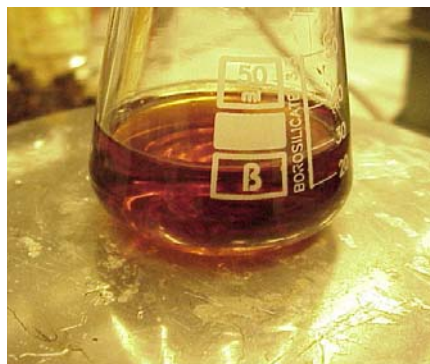
Fig. 49 La miscela etanolo-antociani (filtrato) in fase di concentrazione per evaporazione.
