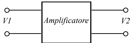
Fig. 52 – Un amplificatore come quadripolo. Nei primi due poli si applica il segnale d'entrata rappresentato dalla differenza di potenziale V1 . Il segnale di uscita è rappresentato dalla differenza di potenziale V2
